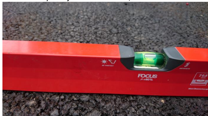
Az útnak enyhe lejtése van bal felé, a vízelvezetés miatt.
