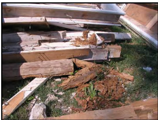
A reves korhadt áthidalók egy darabja kibontás után
